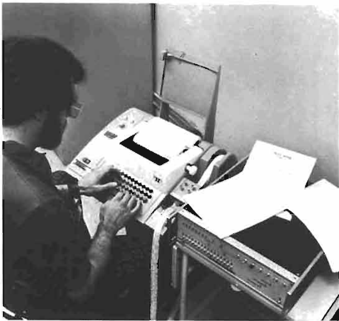
Photo 4. — Le TELETYPE est l'un des terminaux à machine à écrire les plus utilisés en télétraitement.
