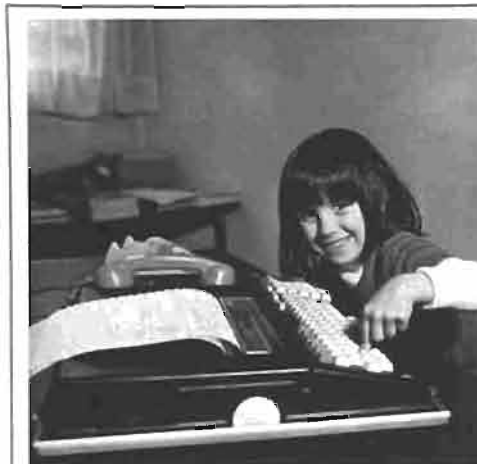
Photo 5. — Le PORTACOM est le premier terminal d'ordinateur portable. Il se présente sous la forme d'un attaché-case de 14 kg, contenant un répondeur téléphonique, une mini-machine à écrire et un modem. « Avec le Portacom, l'interrogation d'ordinateur est d'une simplicité enfantine ».
